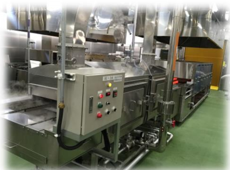
▲蒸し～焼成ライン 「蒸し」「焼き」を連続ラインで。身はふっくら、皮はさっぱりと焼き上げます
