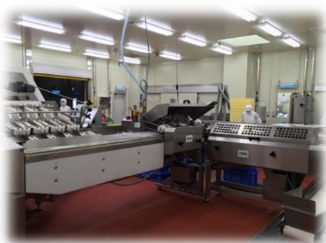
▲自動魚処理機 さんま、いわし等を1秒間に3尾のスピードで開き、3枚卸し加工します
