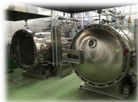
▲レトルト釜×2台 レトルトはもちろん、100℃以下の温度帯での加熱も可能。3段階で温度と時間のプログラム調理も可能です。
