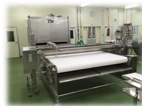
▲シャトルコンベアー 上部縦回転と下部白ベルト横回転が交差し、粉付けされた商品を自動で凍結ラインに並べます。
